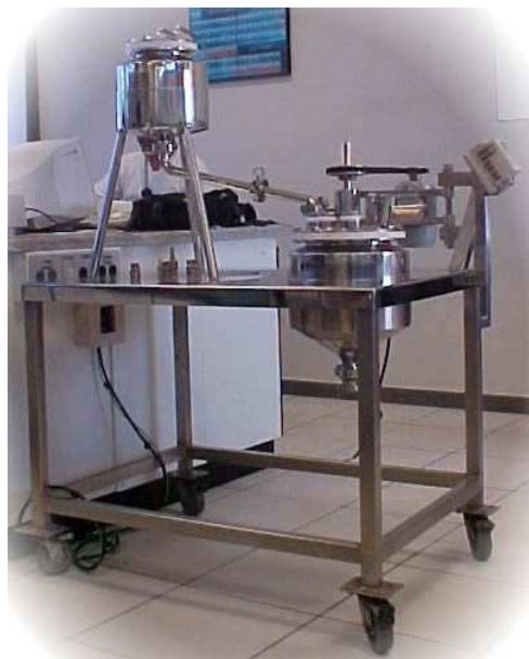
Reator de aço inoxidável 316-L para polimerizações químicas, com tanque de solução de agente oxidante, termostaticado e com velocidade de agitação constante.
