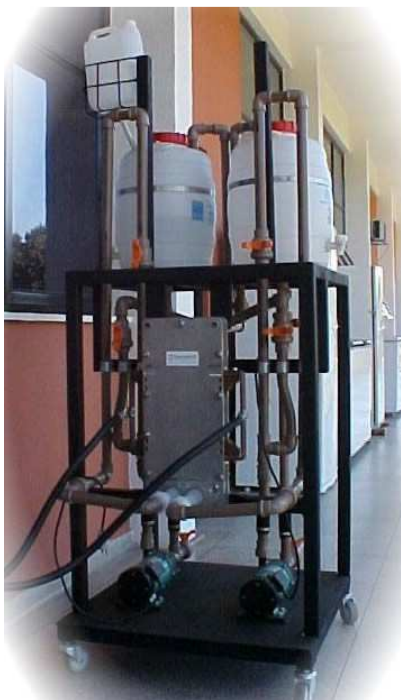
Reator eletroquímico e periféricos utilizado para tratamento de efluentes industriais. Área do eletrodo: 0,8 m 2 . Vazão máxima: 16 L min -1 .
